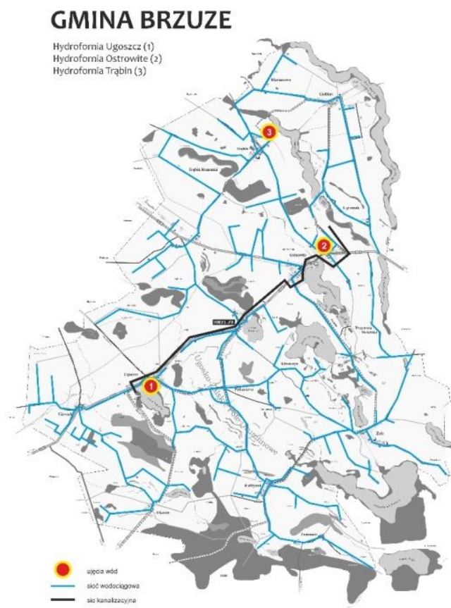
Rys. 24. Schemat sieci wodociągowej w gminie Brzuze
